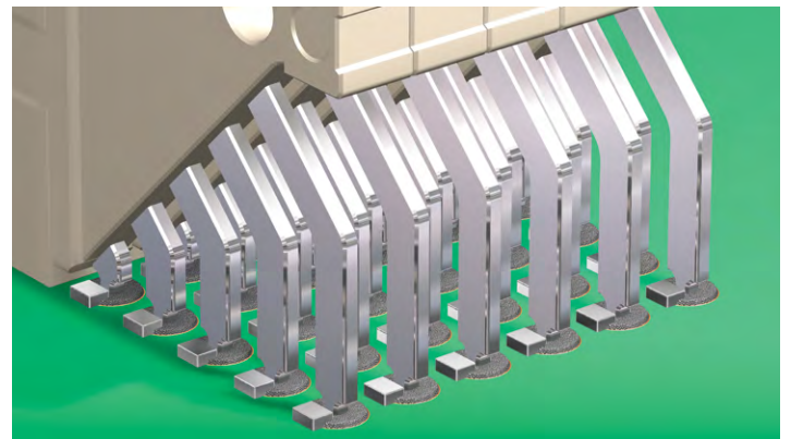
预成型焊片为小间距元件和厚线路板提供额外的焊料,确保100%的填孔和润湿角形成。
