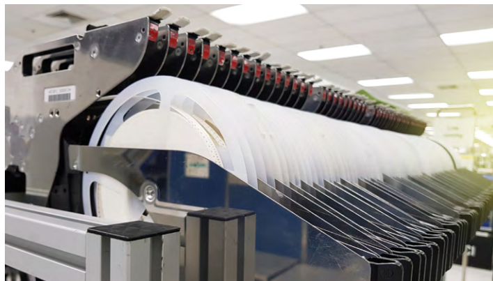
ALPHA Exactalloy 卷带式预成型焊片能使用标准的贴片设备。
