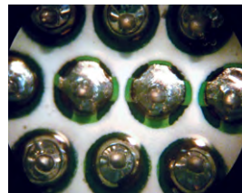
回流后的锡膏和预成型焊片
